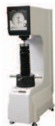
HR-210MR Твердомер по Роквеллу Ручное изменение веса (с выбором общей испытательной нагрузки) и управление предварительной нагрузкой. Моторизованный привод контролирует последовательность нагрузки.
