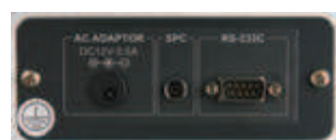
SPC Digimatic и интерфейс RS-232C
