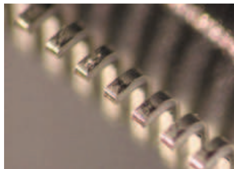
Пример измерения : высота пиков на QFP-корпусе
