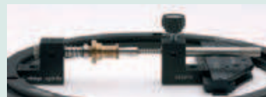
Удерживает цилиндрическую деталь между крепежными наконечниками.
