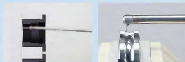
Двухсторонний щуп для измерений в направлениях вверх и вниз
