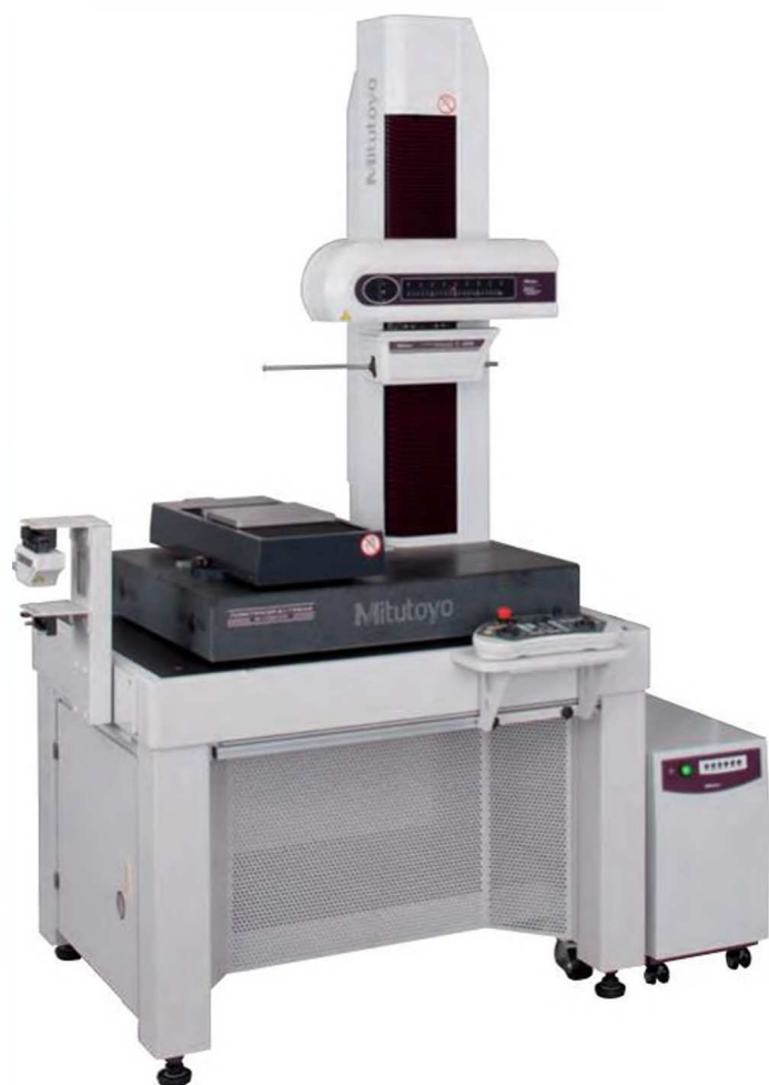
SV-C4500CNC оснащен двумя мощными сменными приводами
