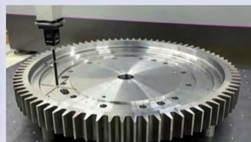
Сканирование головкой SP80 и щупом 100 мм.
