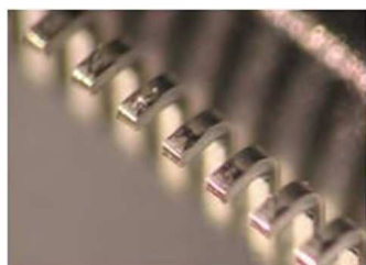
Пример измерения : высота пиков на QFP-корпусе
